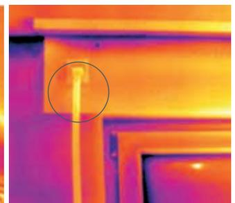
Abb. 21: Thermografie von innen, nach den Dämmmaßnahmen
