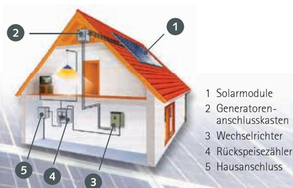
Abb. 33: Schema einer Photovoltaik-Anlage zur Stromerzeugung
